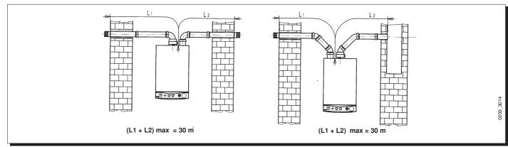
注意:对丁 C52 型号,其连接助燃空气的吸入管和排烟管的端部件绝对不能安装在面向建筑物的墙面上。
