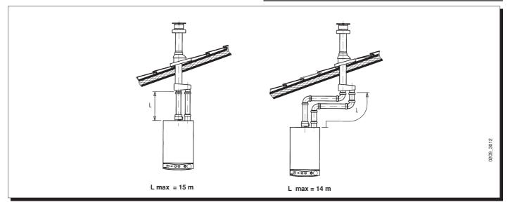
重要:如果安装一个单独的排气管,无论烟管经过屋 墙的什么地方都要确保它有满足要求的保温措施(比 如玻璃纤维)。
